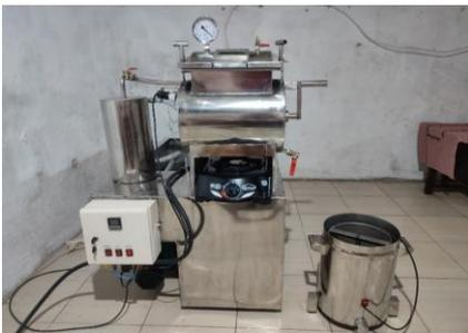
**Gambar 1.** *Mesin Vacuum Frying yang digunakan untuk pengolahan stik tape*
